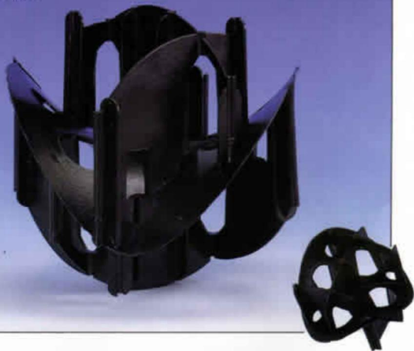
將浮動球散亂地投入接觸曝氣槽內，它們彼此間會自然地形成固定濾床，不需要預備濾材支撐裝置。因為浮動球比重小於1，填充的浮動球會像冰原一樣浮在水中，大部份在水面下，再加上其特殊形狀互相組合，浮力和壓力均衡結果，形成團塊狀的完全固定濾床。
