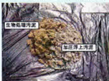
生物処理余剰汚泥&加圧浮上汚泥処理前
