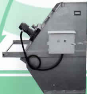
タイマー付操作盤
