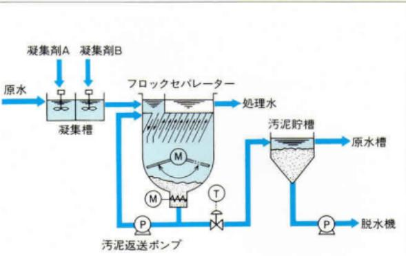
凝集フロック化した原水を、返送汚泥の再利用により更に沈殿性を良くし、大きなフロックは、下向流傾斜板で沈降分離します。
