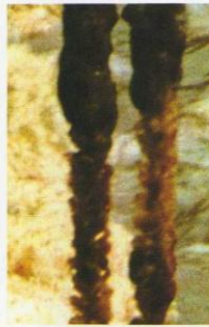
DBレース接觸材の 汚泥付着状況
