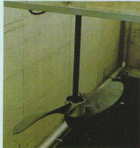
垂直軸水中攪拌機 羽根直径 2.55m 回転数 15~110RPM
