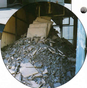
脱水機より排出された 汚泥ケーキ貯留基地。
