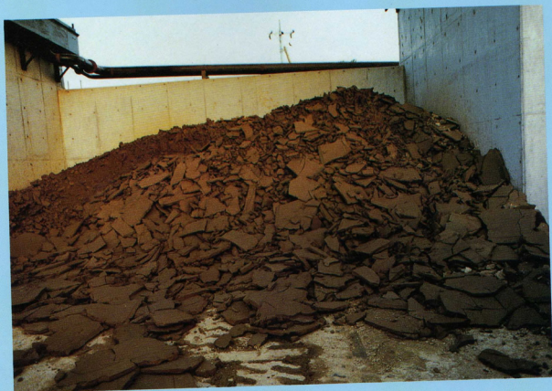
▲自動落下された脱水ケーキ
