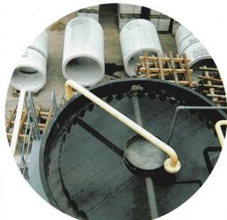
SE-750NZ型10P・毎時30t/h ケーキホッパー付 シックナー式
