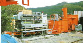
SE-750NZ型 1回脱水ケーキ量300ℓムーブ型 プレス脱水機械。
