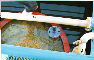
高分子一液によりSS反応 シックナー分離槽 (原水濁度11,200PPm)
