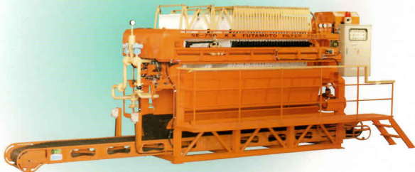
SE-750シリーズ 機械本体ケーキ搬出ベルトコンベア取付型 濾過水排出スライドパン式 濾過容量1回脱水ケーキ量650ℓ型 濾過面積37m 2
