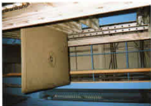
再利用の目的で脱水された自動落下中のベントナイト汚泥ケーキ
